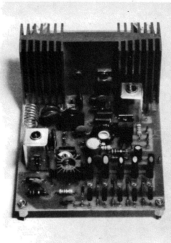
Foto del trasmettitore visto dal lato dei quarzi. Si noti il trimmer R10 (al centro dietro ai quarzi) necessario per regolare la tensione di alimentazione del TX.
