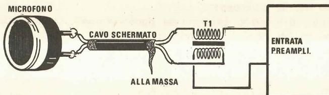
Eccovi tre esempi di come sia possibile evitare che uno stadio preamplificatore di BF collegato ad un trasmettitore possa introdurre inneschi a causa di residui di AF che lo raggiungano attraverso l'alimentazione o il cavetto microfonico.
