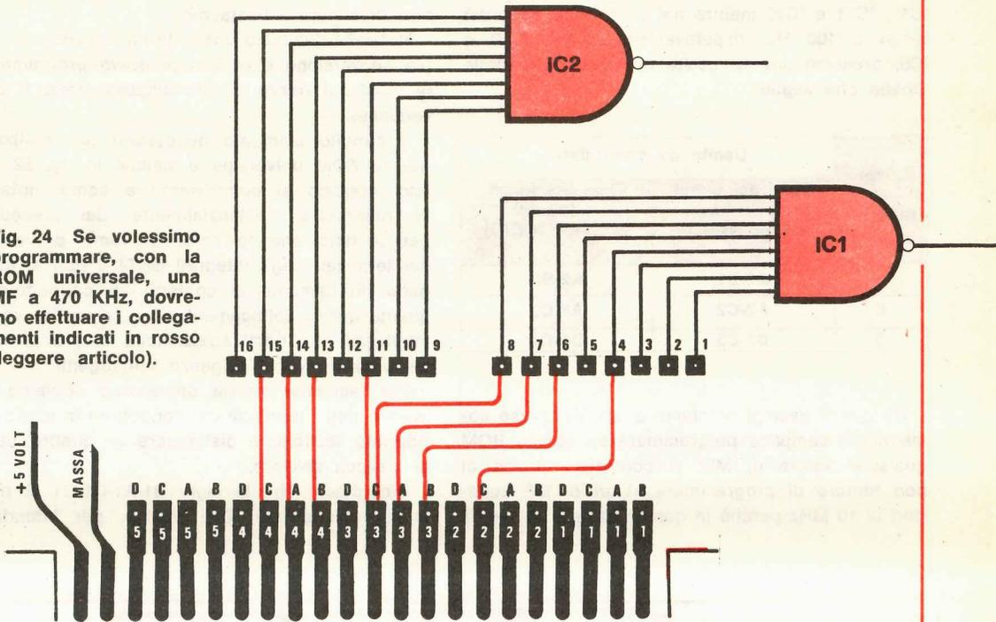
Fig. 25 In questo secondo esempio vi mostriamo invece come si potrebbe programmare un valore di MF a 3,56 MHz. Riteniamo con questi due esempi di avervi svelato quanto sia facile tale programmazione.
