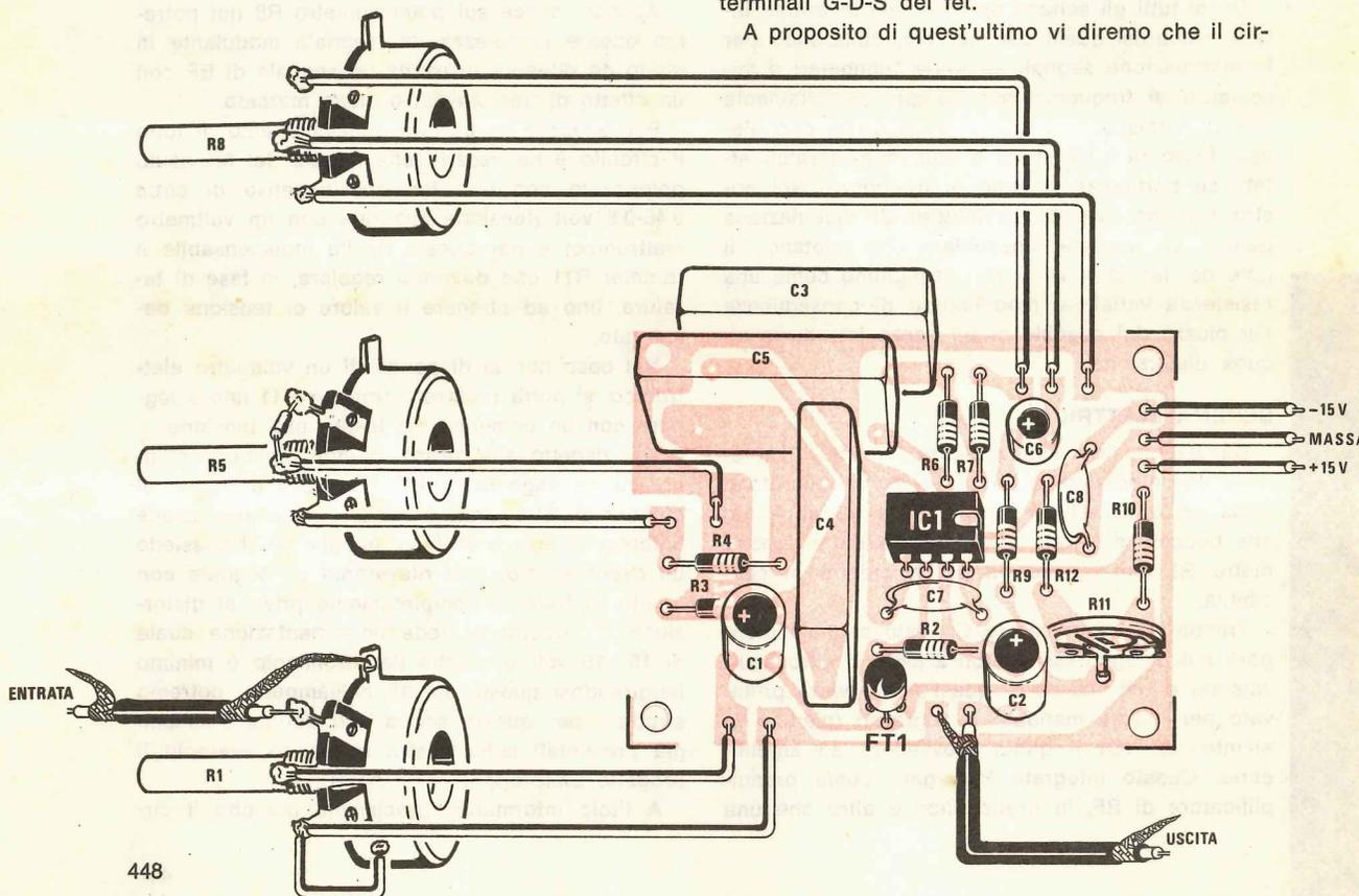
cuito funziona egualmente bene anche con una tensione di 12+12 volt. Per concludere potremmo accennare che il segnale di BF in uscita ha un'ampiezza massima di circa 10 volt picco-picco e che la banda passante dell'amplificatore va da un minimo di 20 Hz ad un massimo di 30.000 Hz circa.
