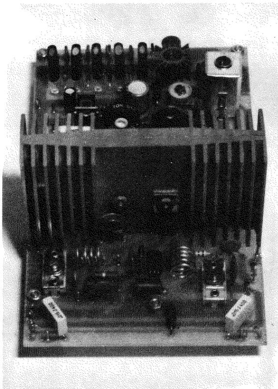
Foto del trasmettitore visto dal lato opposto al precedente. Si notino in basso i due condensatori (posti obliquamente sullo stampato) e la resistenza relativi al misuratore di SWR.
