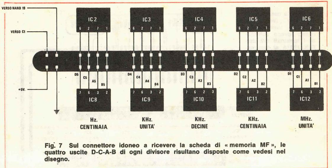
**Fig. 7** Sul connettore idoneo a ricevere la scheda di «memoria MF», le quattro uscite D-C-A-B di ogni divisore risultano disposte come vedesi nel disegno.
