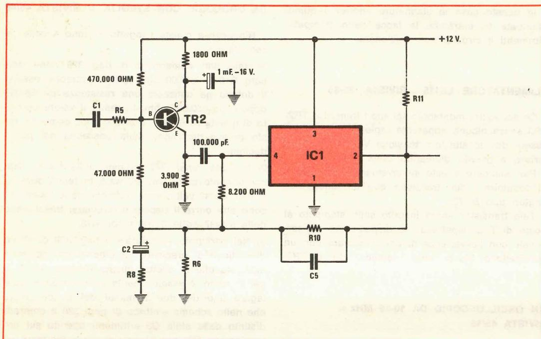
b) collegare la base di TR2 all'alimentazione positiva con una resistenza da 470.000 ohm
