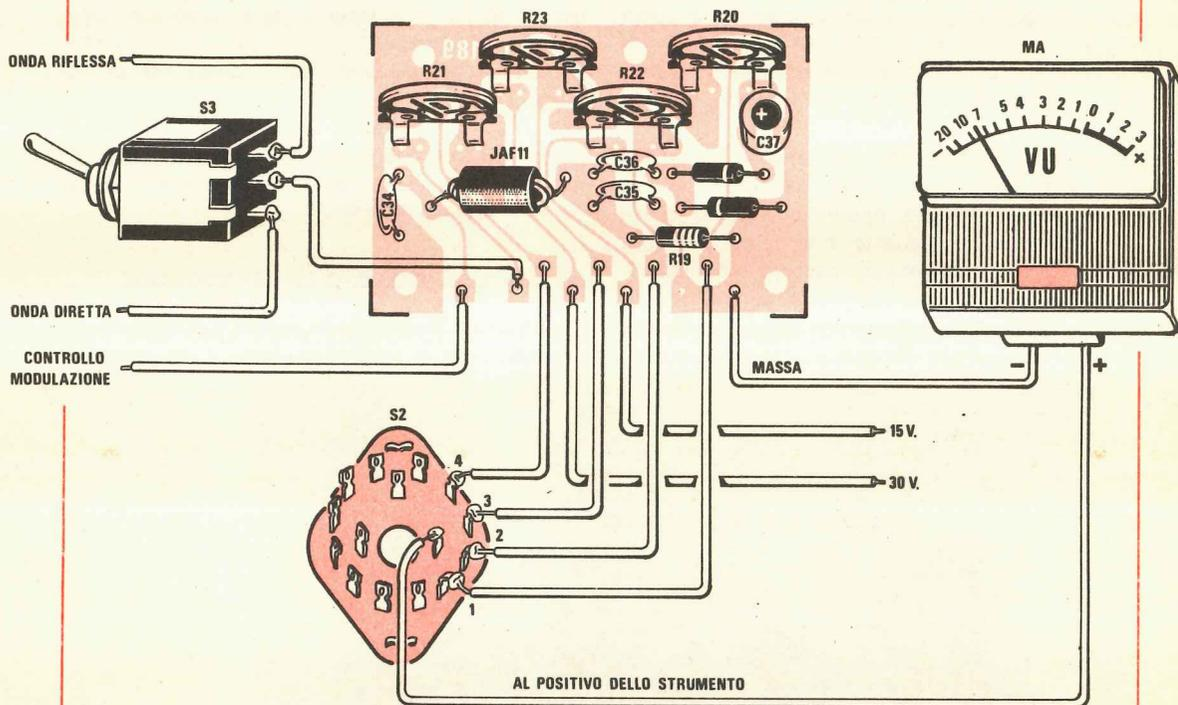
quanto esso ci permetterà di controllare direttamente non solo l'alta frequenza che eroghiamo ma soprattutto quale parte di questa alta frequenza viene « rifiutata » dall'antenna per disadattamento d'impedenza.
