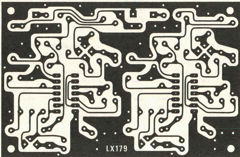
Fig. 27 Circuito stampato idoneo a ricevere il doppio preamplificatore di AF.
