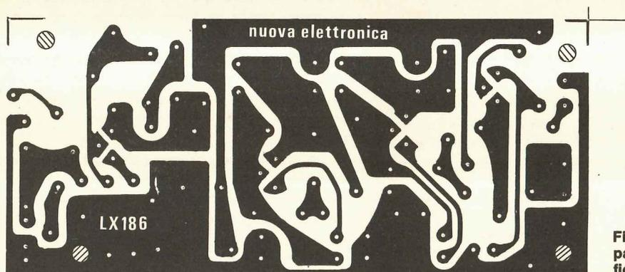
Fig. 8 Circuito stampato del preamplificatore.
