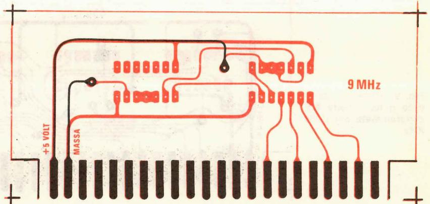
**Fig. 13** Schema pratico di montaggio della MF a 9 MHz.
