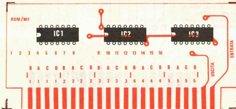
Fig. 24 Se volessimo programmare, con la ROM universale, una MF a 470 KHz, dovremmo effettuare i collegamenti indicati in rosso (leggere articolo).
