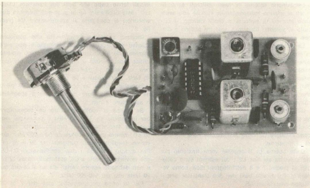
**Questo semplice convertitore vi permetterà di ascoltare, su un qualsiasi ricevitore ad onde medie, le emittenti CB oppure, modificando semplicemente le bobine di antenna e quella dell'oscillatore, qualsiasi altra stazione ad onde corte o VHF.**
