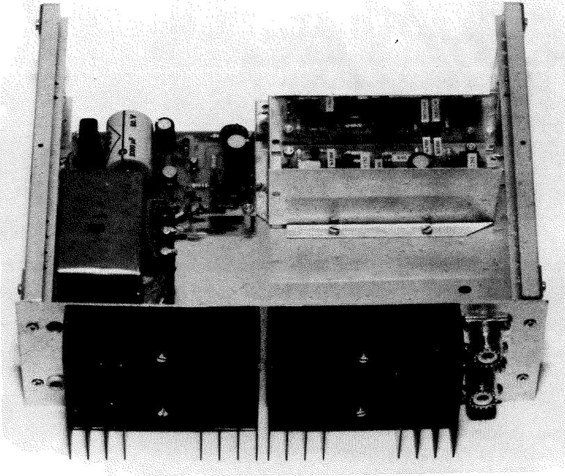
I due transistor di potenza TR5-TR6 dovranno essere sistemati dietro alle due alette di raffreddamento visibili sulla parte posteriore del mobile.
