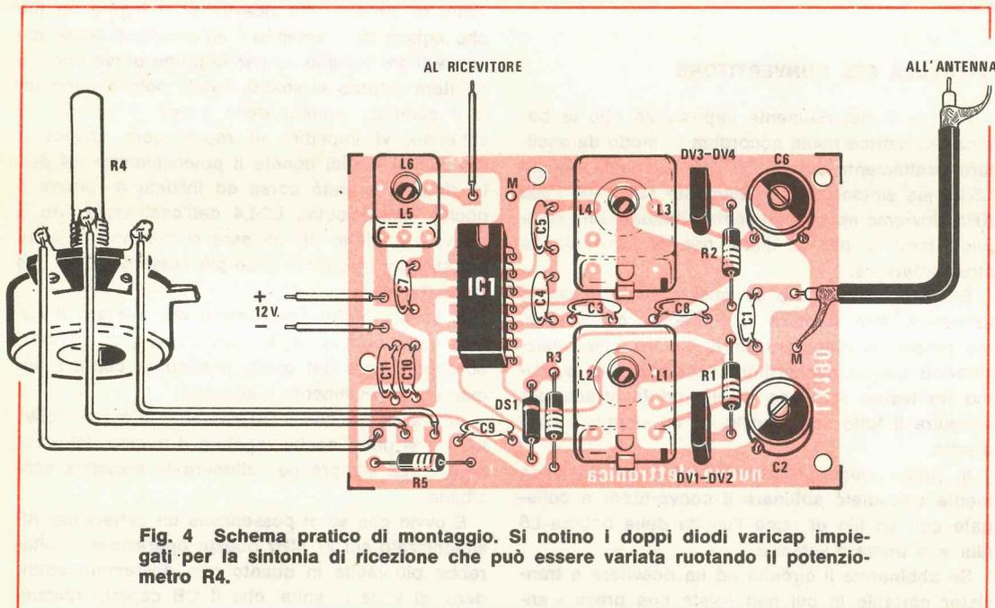
Fig. 4 Schema pratico di montaggio. Si notino i doppi diodi varicap impiegati per la sintonia di ricezione che può essere variata ruotando il potenziometro R4.
