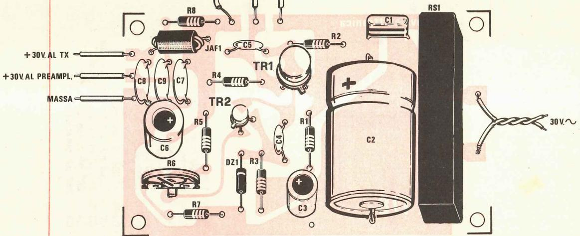
tare un TX, è dotato di condensatori di disaccoppiamento nonché di un'impedenza AF (JAF1) tipo VK200 utile ad evitare che residui di alta frequenza possano entrare nell'alimentare modificando la polarizzazione dei transistor.
