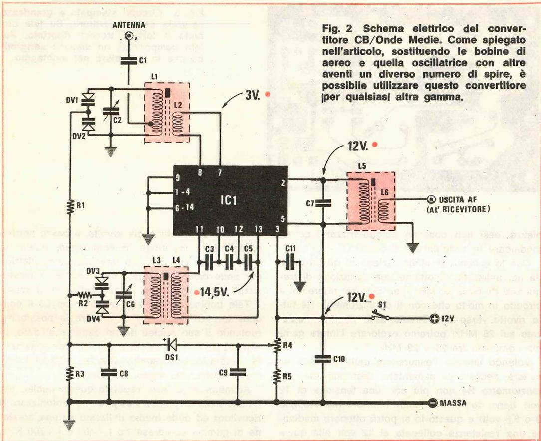
Fig. 2 Schema elettrico del convertitore CB/Onde Medie. Come spiegato nell'articolo, sostituendo le bobine di aereo e quella oscillatrice con altre aventi un diverso numero di spire, è possibile utilizzare questo convertitore per qualsiasi altra gamma.
