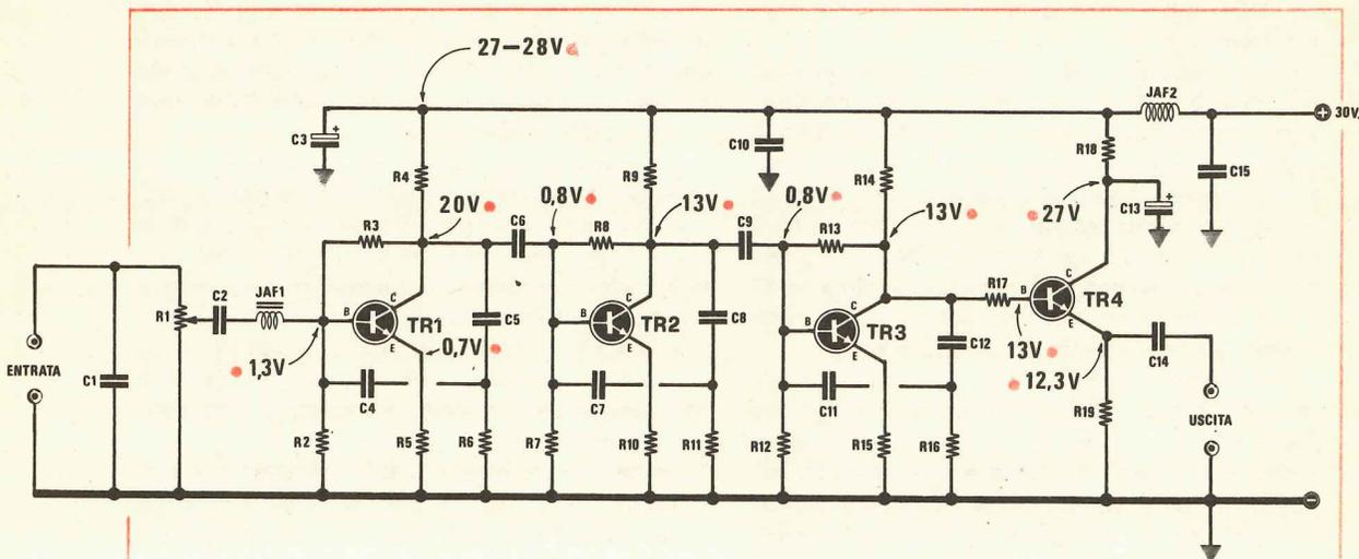
Fig. 3 Schema elettrico del preamplificatore di BF.
