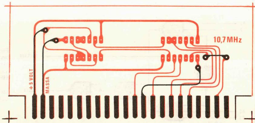
Fig. 16 Schema pratico di montaggio della MF a 10,7 MHz
