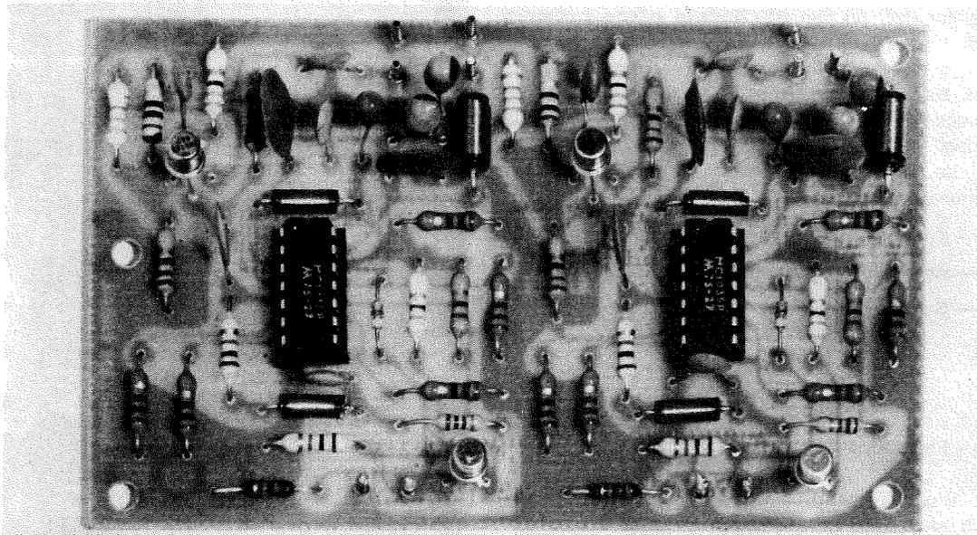
**In questa foto vi presentiamo il doppio preamplificatore di AF che necessariamente dovremo inserire fra il TX-RX e la scheda LX180/A. Questo preamplificatore serve per frequenze massime di 40 MHz.: per frequenze superiori, tale scheda va sostituita con il prescaler che presenteremo sul prossimo numero.**
