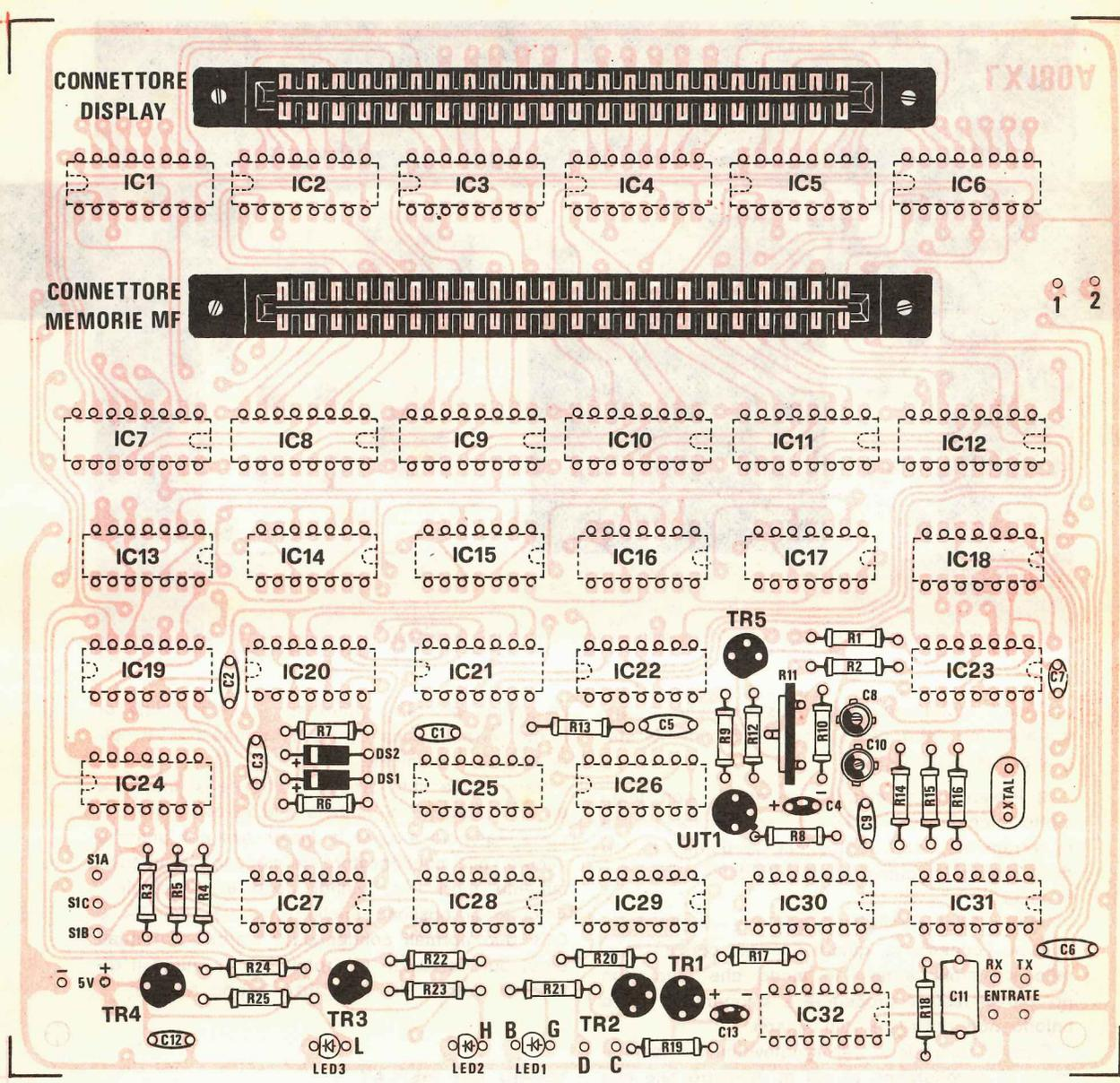
Fig. 1 Sul circuito stampato LX180/A il lettore troverà riportato questo disegno serigrafico utile per individuare l'ubicazione dei diversi componenti. **NOTA IMPORTANTE.** Sulla destra sono invertite le scritte ENTRATA RX e ENTRATA TX quindi occorre applicare il segnale del TX dove è scritto RX e viceversa.
