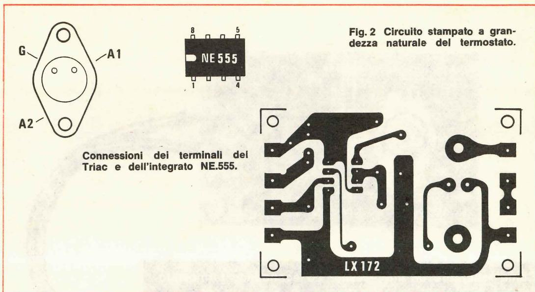
Fig. 2 Circuito stampato a grandezza naturale del termostato.
