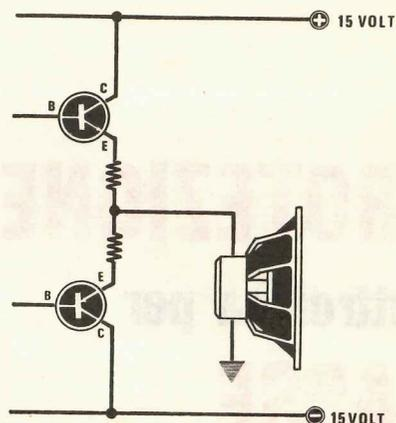
**Fig. 1** Il circuito di protezione per casse acustiche serve solo ed unicamente per gli amplificatori alimentati con tensione duale. In questi amplificatori infatti, se un transistor va in corto, tutta la tensione di alimentazione si riversa sulla bobina mobile dell'altoparlante.
