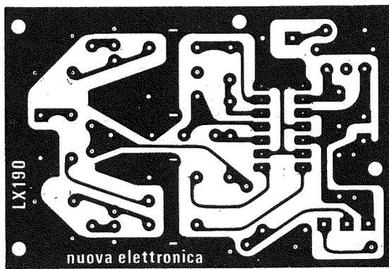
Fig. 3 Circuito stampato a grandezza naturale del convertitore. Su tale circuito il lettore troverà riportato, dal lato componenti, un disegno serigrafico che lo agevolerà nel montaggio.
